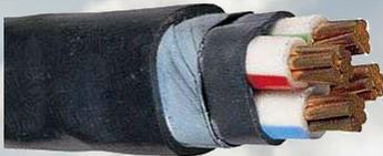
Кабель ВБбШв: медный поливинилхлорид по жиле, поливинилхлоридная оболочка, броня из оцинкованных стальных полос, герметичный внешний шланг. Может применяться везде, где существует опасность механических повреждений проводки в процессе эксплуатации.
