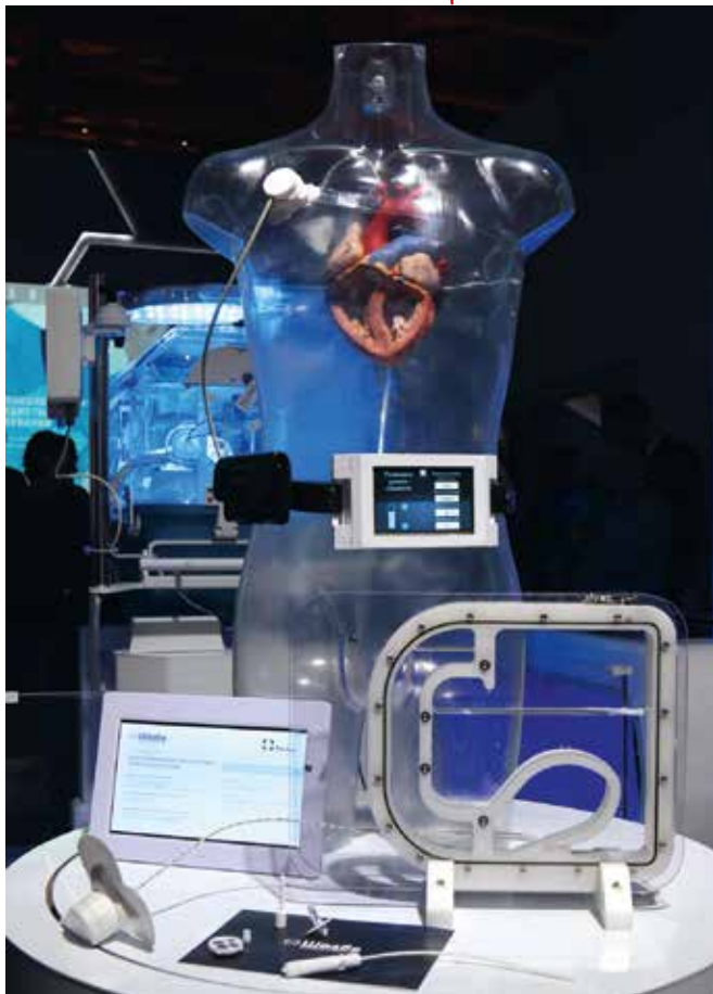
«Инвента» — искусственный желудочек сердца. Уже в ближайшие годы он может стать реальной альтернативой операции по пересадке донорского сердца
