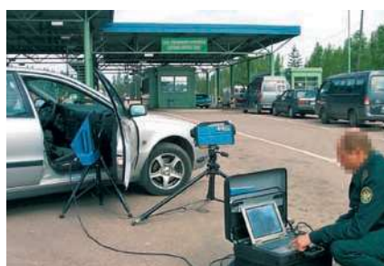
Работа с переносным рентгенотелевизионным комплексом «Шмель-240ТВ»
