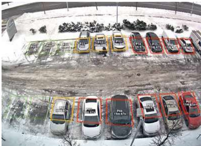
Датчик парковки KiwiVision определяет, какие места свободны (зеленые), какие заняты менее 10 минут (желтые), какие — более (красные)
