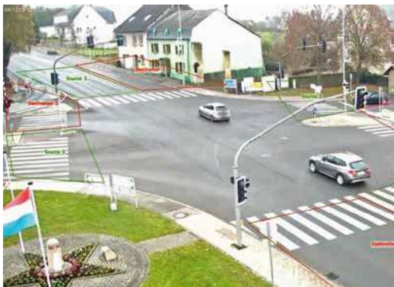
Датчик загруженности дорог KiwiVision определяет количество машин на перекрестке
