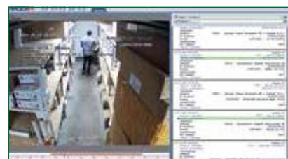
Модуль TRASSIR Shelf Detector позволяет в автоматическом режиме отслеживать наличие продукции на полках
