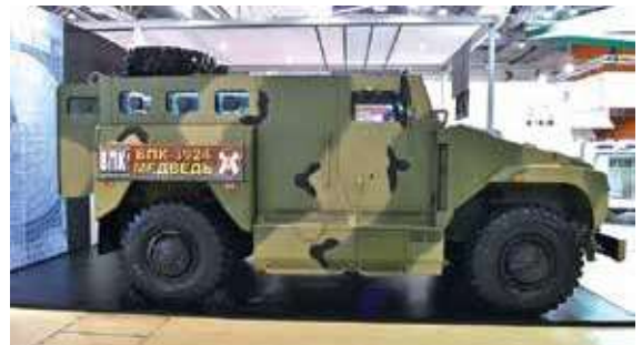
▲ Броневысокий автомобиль с усиленной противоминной защитой «Медведь»
