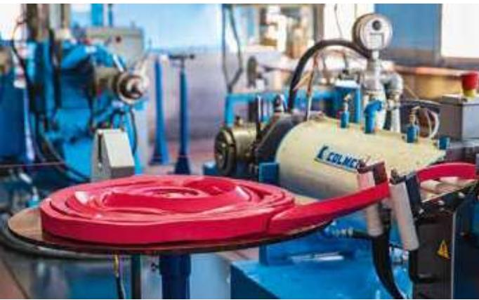
Специальный силиконовый шнек, цилиндр и головка экструдера оснащены системой автоматического охлаждения, поддерживающей постоянную температуру для защиты от преждевременной вулканизации. Далее изолированная силиконом жила подается в печь вулканизации, где при температуре 300 °С и происходит сшивка резины, после чего она превращается в привычный для нас эластичный материал.
