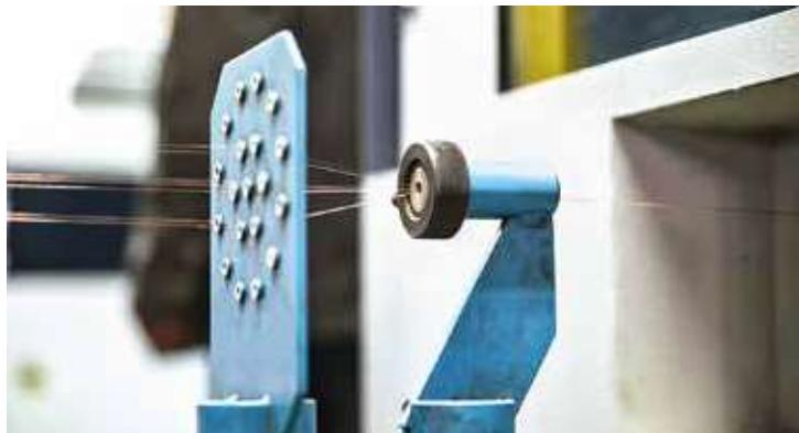
очень гибкие жилы, в состав которых порой входит до 40–50 проволочек малого диаметра. Это позволяет кабелям работать много лет даже при постоянных изгибах.
