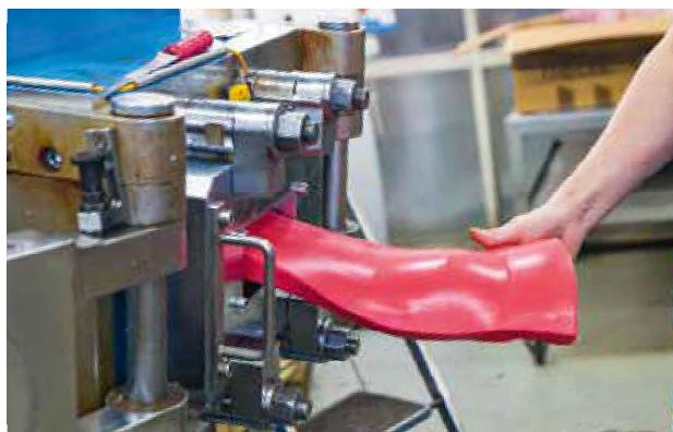
Время выдавливать из «теста» готовый брускок. Оператор подсоединяет к аппарату заглушку с выпускным отверстием, которое
