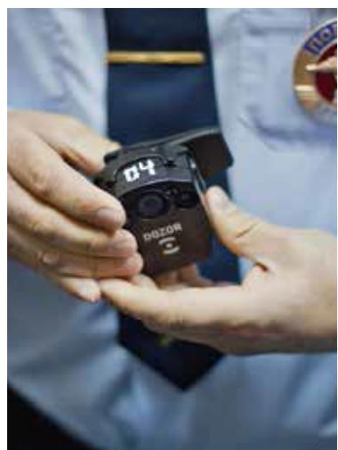
Прибор оснащен объективом и креплением на одежду.
